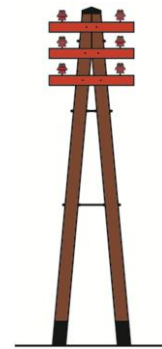
図8 高圧送電線用A柱 33)
