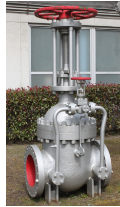
写真7 戸畑発電所主蒸気止弁(岡野バルブ製造株式会社所蔵)
