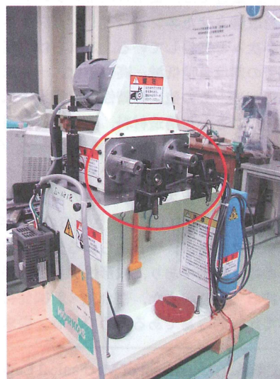
図 3 4 連式片持ち回転曲げ疲労試験機
