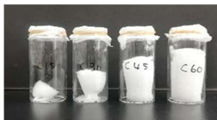
図 4 超音波処理後の上澄み溶液の凍結乾燥精製物
