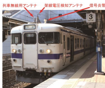
写真2 下関行き普通列車と地板付列車無線用アンテナ (小倉駅にて 平成30年3月, 撮影 加島 篤)
