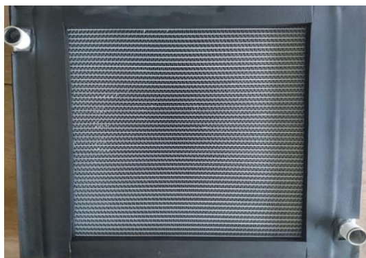
図2.1 熱交換器実験用サンプル (ラジエーター)
