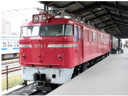
写真8 ED72形交流電気機関車(北九州市門司区九州鉄道記念館保存)
