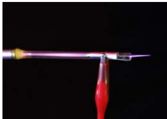
図 3 作製した LF プラズマ装置から発生したプラズマジェットの様相
